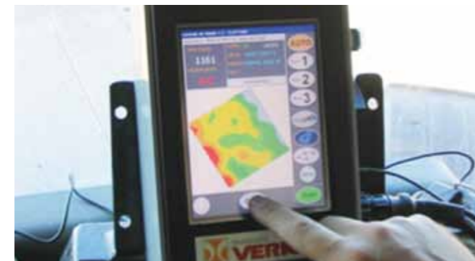
Figura 3 – Controlador de aplicação em taxa variada (esquerda) e máquina aplicando adubo em soqueira em Taxa Variada de acordo com a tecnologia do IDT.
