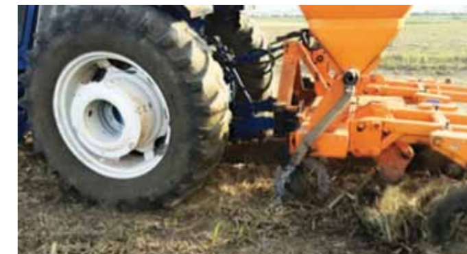
Figura 3 – Controlador de aplicação em taxa variada (esquerda) e máquina aplicando adubo em soqueira em Taxa Variada de acordo com a tecnologia do IDT.
